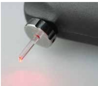
Figura 1.25 DIAGNOdent pen KaVo. Si tratta di uno strumento che non elabora immagini ma solo valori numerici. 0-7: assente o scarsa attività batterica; 8-15: attività batterica più intensa; >16: possibile presenza di cavitazione.
